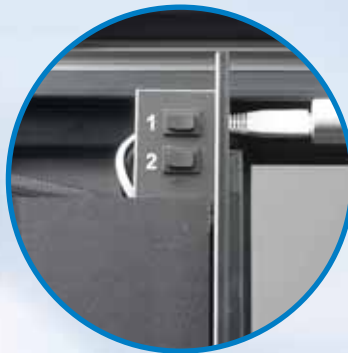
Tasto entrata in programmazione e test vendita accessibili dall'esterno box
